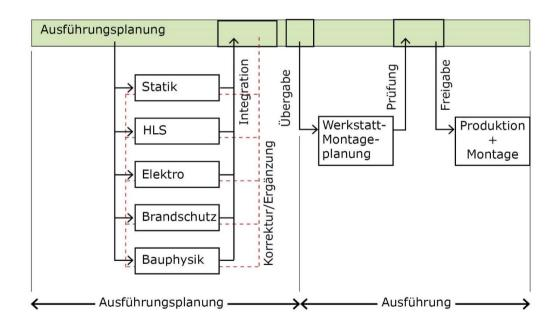
Abb. 1 - Ablauf an der Schnittstelle der Ausführungsplanung zur Ausführung (leanWOOD)
